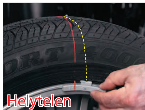
A helytelen felső holtpont meghatározása hibás javítást eredményezhet és hosszadalmas kiegyensúlyozáshoz vezethet fölösleges ellenőrző pörgetésekkel.
