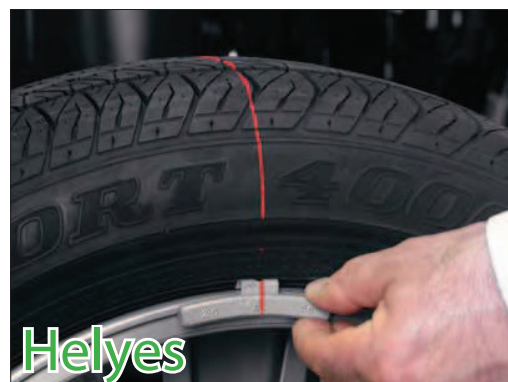
A precíziós súly felhelyezés gyors és könnyű a HammerHead TDC lézer használatával.
